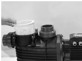
Tägliche Reinigung des Filterkorbes!
